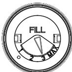
Gire el regulador con la flecha dentro del depósito para cambiar el ajuste del agente de enjuague
