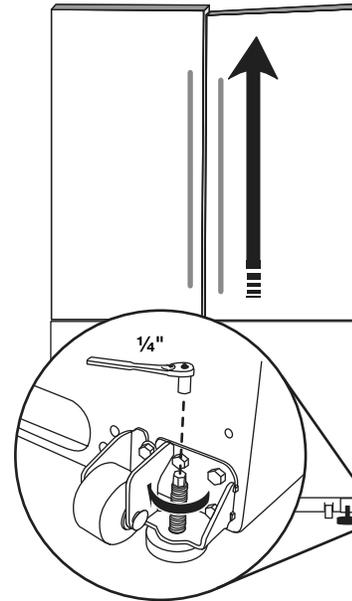
6. Asegúrese de que el refrigerador esté estable. Si el refrigerador parece inestable o se desliza hacia delante cuando se abre la puerta o el cajón, regule los tornillos niveladores. Gire el tornillo nivelador hacia la derecha con una llave hexagonal de 1/4" hasta que los rodillos estén hacia arriba y las patas niveladoras estén firmes contra el piso.
