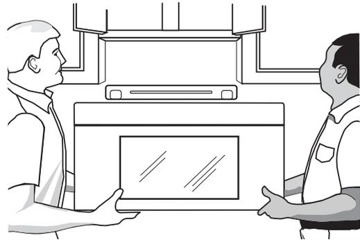
3. Con la ayuda de 2 o más personas, levante el horno de microondas y cuélguelo de las lengüetas de soporte en la parte inferior de la placa de montaje.
