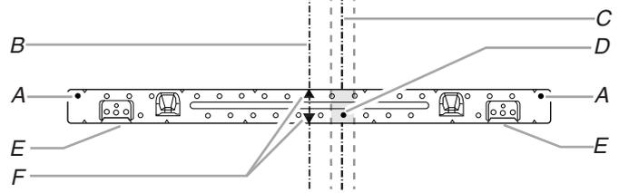
**NOTA:** Si el pie derecho de pared está a no más de 6" (15,2 cm) de la línea central vertical (vea la sección "Marque la pared posterior"), solamente se podrá hacer una instalación con recirculación o una instalación con ventilación en el techo.
