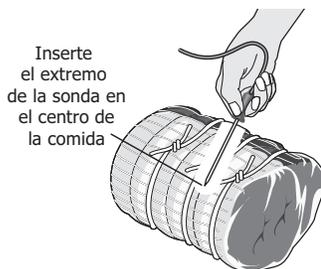
**Figura 22: Colocación adecuada de la sonda**
