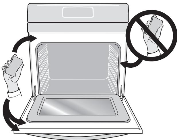
Figura 30: El área de la puerta del horno que se debe y no se debe limpiar (junta).
