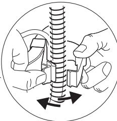
Le tuyau de vidange est maintenu en place à l'aide de deux loquets de verrouillage en plastique. Appuyez sur la languette de verrouillage et dégagéz le tuyau de vidange.
