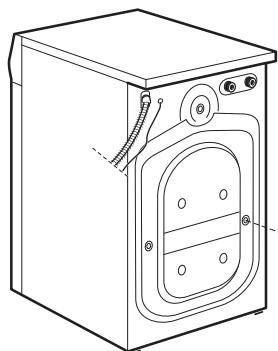
Retire todos los elementos siguientes de la parte trasera de la lavadora:
