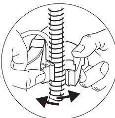
La manguera de desagüe se mantiene fijada con dos piezas de plástico. Presione la pestaña de bloqueo y libere la manguera de desagüe.
