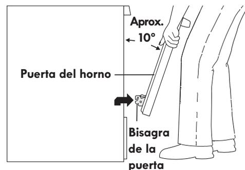
Figura 19: Cómo sujetar la puerta para su extracción
