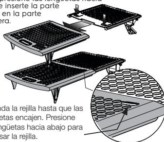
Extienda la rejilla hasta que las lengüetas encajen. Presione las lengüetas hacia abajo para colapsar la rejilla.
