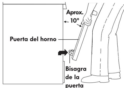
Figura 13: Sujeción de la puerta para su extracción
