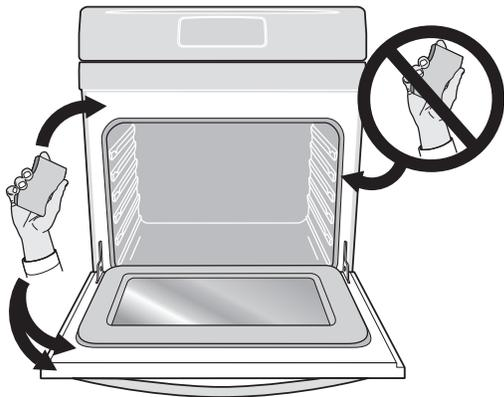
Figura 7: Área de la puerta del horno con lo que se debe y no se debe limpiar (junta).
