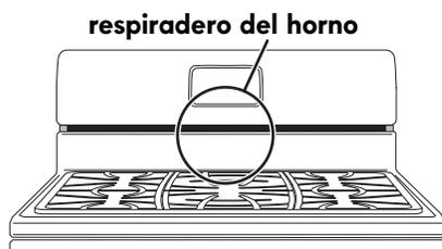
Figura 10: No bloquee la ubicación del respiradero del horno
