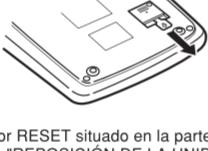
2. Pulse el interruptor RESET situado en la parte posterior de la unidad. (Consulte "REPOSICIÓN DE LA UNIDAD".)
