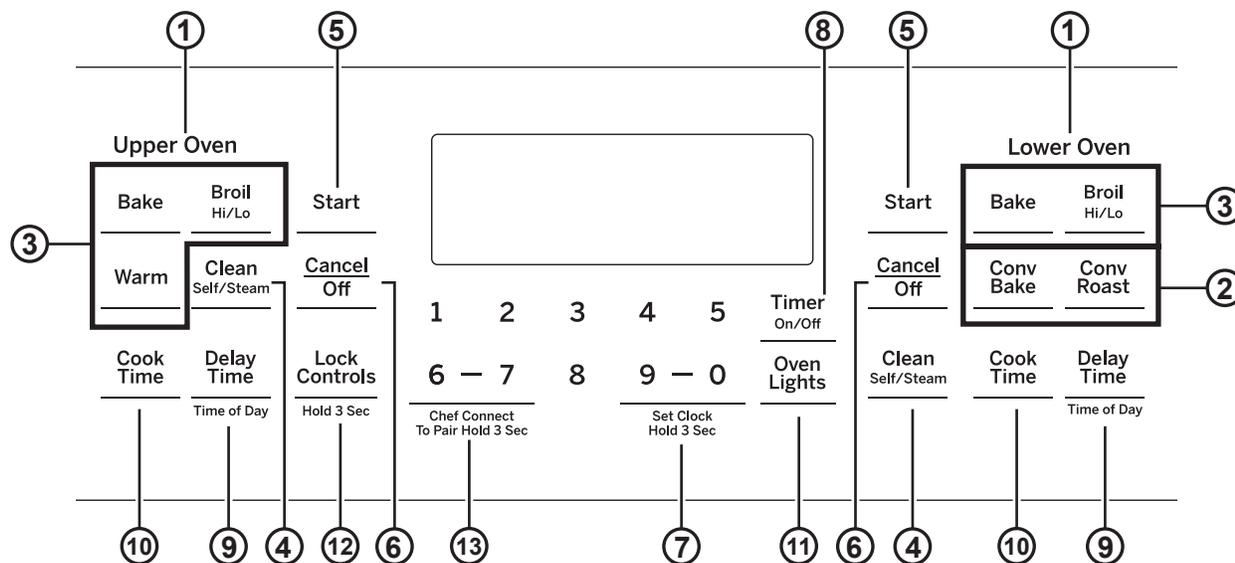
1. **Upper Oven and Lower Oven (Horno Superior y Horno Inferior):** Designa qué horno operarán los controles.
