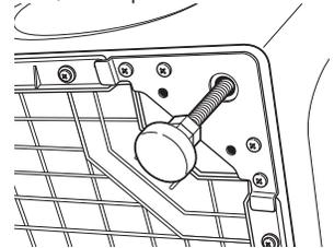
**NOTA:** Mantenga la extensión de los soportes al mínimo para evitar una vibración excesiva. Cuanto más se extiendan los soportes, más vibrará la lavadora.
