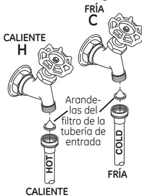
5. Conecte los extremos de la tubería de entrada a las tomas de agua CALIENTE y FRÍA ajustándolos con la mano y, a continuación, apriete de nuevo 2/3 de vuelta con los alicates. Abra la llave de paso y compruebe que no hay ninguna fuga.
