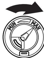
En dirección de las agujas del reloj para reducir las manchas con gotas de agua y agua dura
