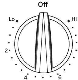
Tanto en **Off (Apagado)** como en **Hi (Alto)**, el control se ajusta en la posición. Es posible que escuche leves sonidos de ajuste durante la cocción, indicando que el control está manteniendo su configuración deseada. Asegúrese de girar la perilla de control a **Off (Apagado)** cuando finalice la cocción.
