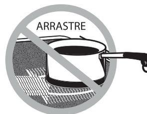
No deslice los recipientes de cocción a través del control y la superficie de la estufa porque puede rayar el vidrio. El vidrio es resistente a los rayones, pero no a prueba de los mismos.
