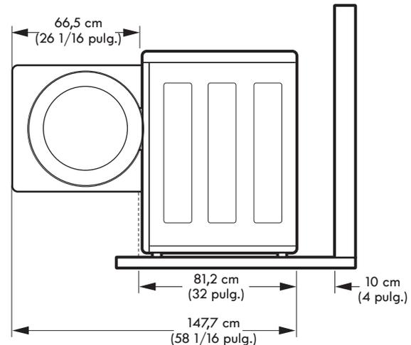
Para asegurar que se haya dotado de suficiente espacio para las tuberías de agua y flujo de aire, deje espacios mínimos de por lo menos 2,5 cm (1 pulgada) en los lados y de 10 cm (4 pulgadas) detrás de la unidad. No olvide tener en cuenta las molduras de paredes, puertas o piso, que podrían aumentar la distancia de separación necesaria.
