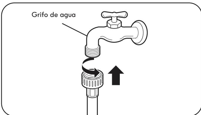
2. Conecte las mangueras de suministro de agua a las llaves de paso de agua caliente y fría y apriete las conexiones con la mano. A continuación, utilice unos alicates para apretarlas otros 2/3 de vuelta.
