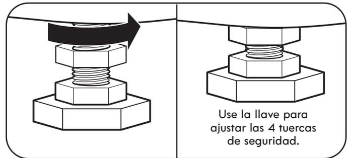
3. Una vez que la lavadora esté nivelada de lado a lado y de adelante hacia atrás, utilice la llave para apretar las cuatro tuercas de fijación y fijelas a fin de evitar que las patas se desajusten durante el funcionamiento. Asegúrese de que las cuatro patas están en contacto directo con el suelo.
