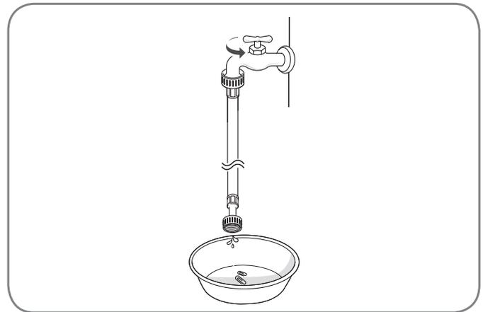
3. Siempre deje fluir uno o dos litros de agua a través de cada manguera de entrada para ayudar a evitar futuros problemas con pantallas de filtro obstruidas al vaciar la suciedad, depósitos de minerales y otros residuos de las tuberías de agua. De paso, al hacerlo comprobará cuál es la manguera de agua caliente y cuál la de agua fría.
