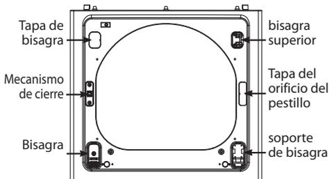
d. Invierta la bisagra y el soporte de la bisagra de la parte inferior del gabinete. Afloje los dos tornillos del soporte de la bisagra de la parte inferior derecha y remueva el soporte de la bisagra. Extraiga el tornillo inferior de los dos tornillos situados detrás del soporte de la bisagra. **NO** retire el tornillo superior situado detrás del soporte de la bisagra. Separe las piezas a un lado.
