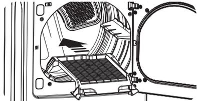
2. Asegúrese de que esté asentado uniformemente sobre el borde interior de la puerta y descanse horizontalmente sobre el interior de la secadora.
