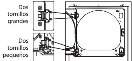
Si la puerta no funciona correctamente, retírela y abra la tapa para comprobar el correcto montaje y alineación de las barras de bloqueo y los botones de enclavamiento.
