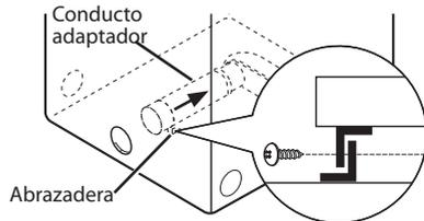
3. Inserte el codo de 4 pulgadas (10,2 cm) a través de la abertura trasera y apriételo en el conducto adaptador. Asegúrese de que el extremo macho y el codo apunten hacia abajo por el orificio ubicado en la parte inferior de la secadora. Asegúrelo en su lugar con cinta adhesiva impermeable. Conecte la placa de cubierta a la parte trasera de la secadora con el tornillo provisto.
