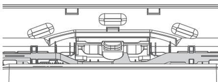
a. Deslice la barra de bloqueo a la derecha para retirarla del ensamblaje de la bisagra del lado izquierdo.
