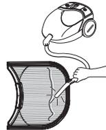
3. Si el filtro de pelusas se ha ensuciado mucho o se ha obstruido con suavizante de tejido, lávelo en agua caliente jabonosa y déjelo secar completamente antes de volverlo a colocar.
