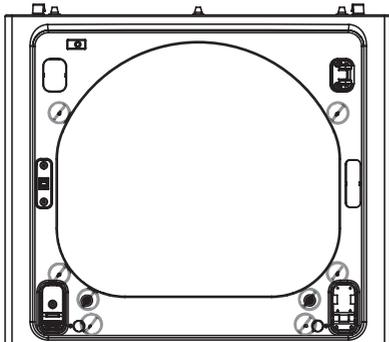
e. Suelte los tres tornillos de la bisagra de la parte inferior izquierda. Extraiga la bisagra e reinstálela en el lado derecho. El tornillo superior ocupa el orificio del que se ha extraído el tornillo situado detrás del soporte de la bisagra en el paso d.
