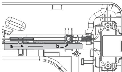
b. Mientras desliza la barra de bloqueo derecha, levante el extremo derecho y sepárela de las guías.
