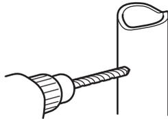
**REMARQUE :** La conduite de raccordement ne peut pas être un tuyau en plastique blanc. Les plombiers agréés ne doivent utiliser que des tuyaux en cuivre NDA n° 49595 ou 49599 ou des tuyaux en polyéthylène réticulés (PEX).
