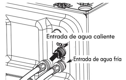
**ADVERTENCIA:** No reutilice mangueras viejas. Utilice mangueras nuevas para la instalación de la lavadora. Las mangueras viejas pueden tener fugas o reventar causando inundaciones y daños materiales.
