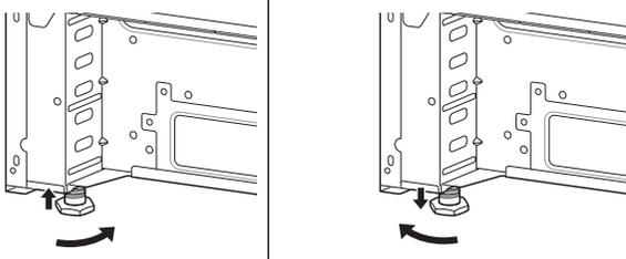
Utilice un nivelador para verificar sus ajustes. Ubique el nivelador en diagonal sobre el estante del horno y verifique en todas direcciones para nivelar.
