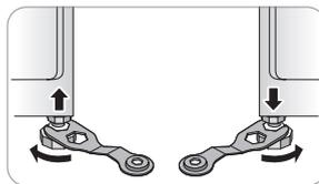
Suba o baje la unidad utilizando las patas de nivelación hasta que el Styler esté nivelado de lado a lado y de adelante hacia atrás.
