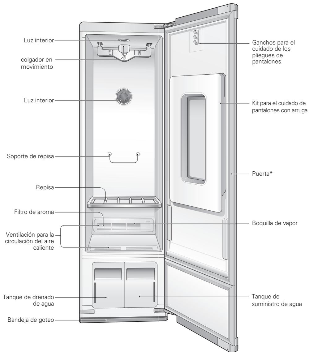
\* La apertura de la puerta puede ser revertida por el instalador para adaptarse a la ubicación de la instalación.
