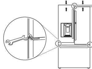
La puerta derecha del refrigerador no tiene una tuerca ajustable.
