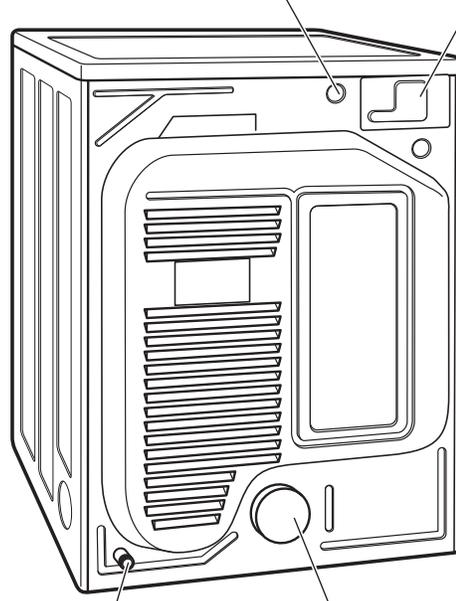
Ubicación de la conexión de gas (modelos a gas)
