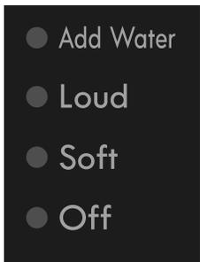
Antes de usar un ciclo de vapor, debe llenar con agua el alimentador de vapor hasta la línea MAX; asegúrese de que la gaveta esté completamente cerrada. Si el alimentador de vapor se queda sin agua, el indicador ADD WATER parpadeará. Si lo hace, apague la secadora, llene el alimentador y reinicie el ciclo de vapor.
