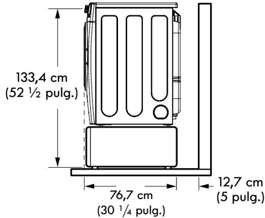
Dimensiones requeridas para la instalación con el kit para montaje sobre la lavadora
