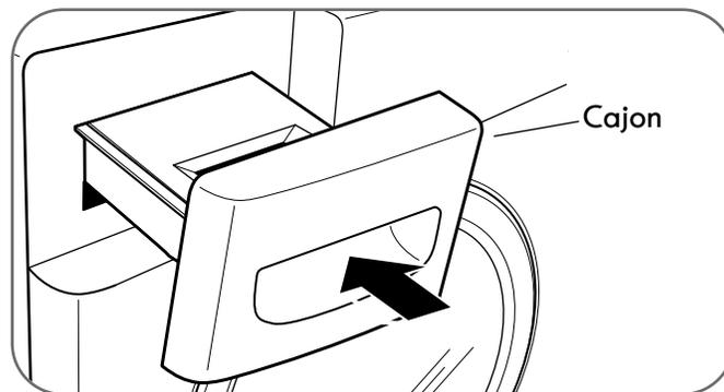
4 Coloque el alimentador de vapor en la gaveta y empújela hasta que haga clic en su posición.
