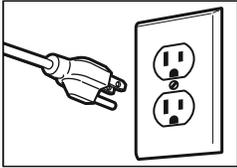
Las secadoras de gas requieren una toma de corriente de 120 V de CA, 60 Hz y tres clavijas con toma de tierra.
