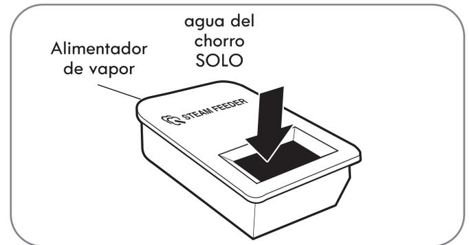
3 Llene el alimentador de vapor con agua corriente del chorro hasta la línea MAX o hasta que el agua toque la malla del filtro.
