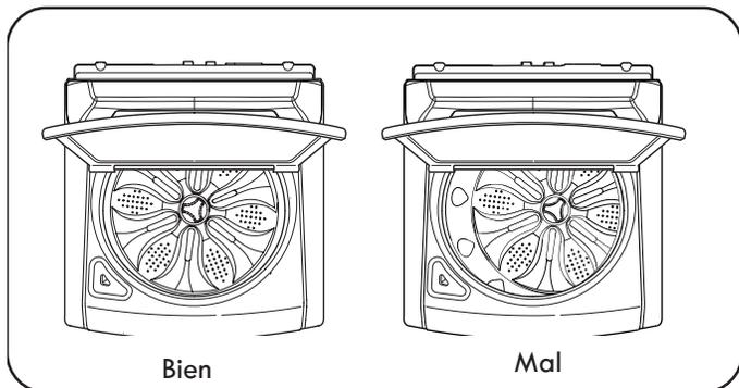
3. Para asegurarse de que la lavadora está correctamente nivelada, abra la tapa y mire desde arriba para ver si la tina está centrada. Si la tina NO está centrada como muestra el dibujo de la derecha, vuelva a ajustar la pata. Si tiene un nivel, compruebe la lavadora con el nivel.
