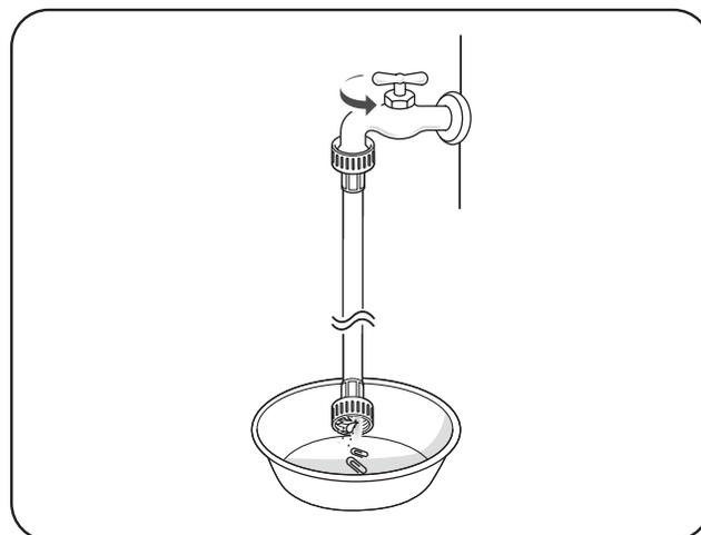
3. Siempre deje fluir uno o dos litros de agua a través de cada manguera de entrada para ayudar a evitar futuros problemas con pantallas de filtro obstruidas al vaciar la suciedad, depósitos de minerales y otros residuos de las tuberías de agua. De paso, al hacerlo comprobará cuál es la manguera de agua caliente y cuál la de agua fría.
