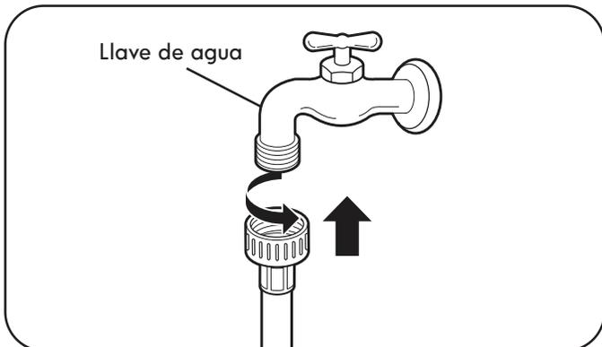
4. Conecte la tubería de agua caliente (roja) a la entrada de agua caliente ubicada en la parte trasera de la lavadora. Conecte la tubería de agua fría (azul) a la entrada de agua fría situada en la parte posterior de la lavadora. Ajuste las uniones con firmeza. Abra las llaves de paso del agua y revise si hay fugas.
