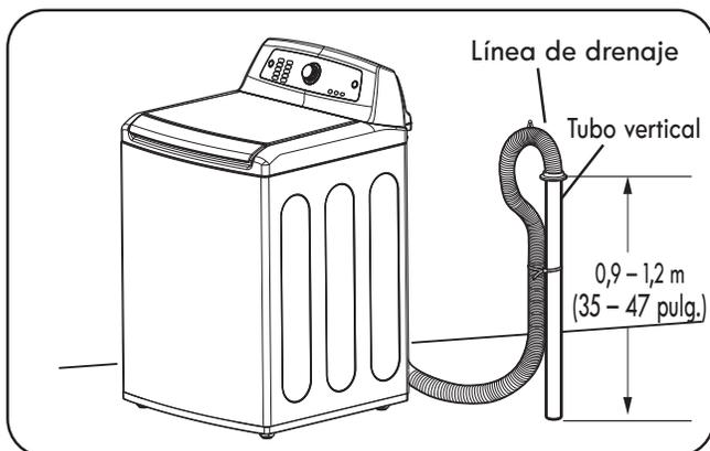
Doble el extremo de salida de la manguera de drenaje hasta formar una U. Ingrese el extremo de la manguera de drenaje en el desagüe. Si el desagüe es lo suficientemente ancho como para que el reborde de la manguera encaje dentro, entonces, no inserte el reborde más de 2-5 cm (1-2 pulgadas) en el desagüe. Use la correa, incluida con los materiales de instalación que había en el bloque de espuma de la tina, para asegurar la manguera de drenaje al desagüe.
