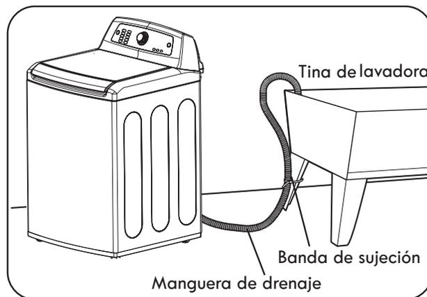
Doble el extremo de la manguera de drenaje hasta que tenga la forma deseada y engánchelo al borde del lavadero. Use una correa para asegurar la manguera de drenaje en su lugar.
