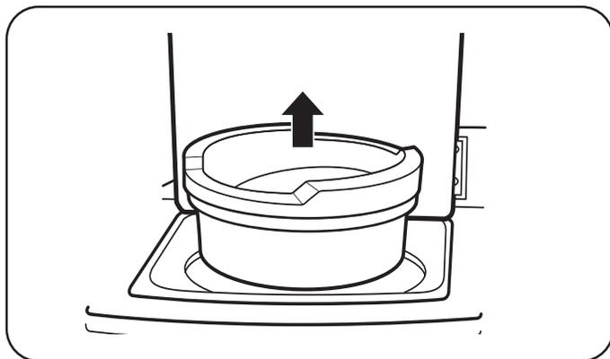
2. Retire el bloque de espuma que contiene el manual del propietario, las piezas, de agua y las muestras de producto de lavandería. Guarde el bloque de espuma para un uso futuro. Si en el futuro debe trasladar en una mudanza la lavadora, este bloque ayudará a impedir daños a la lavadora durante el transporte.
