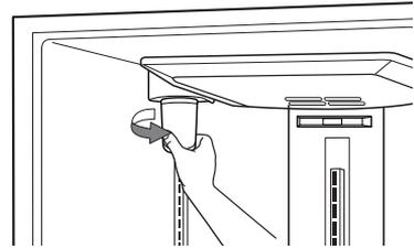
Después de sustituir el filtro, deje que circulen por el filtro unos 9,5 litros antes de su uso (unos 5 minutos de circulación). Revise posibles fugas que pueda haber en el filtro.
