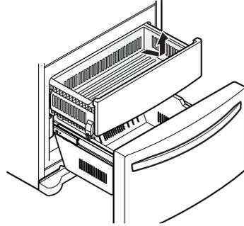
Para volver a instalarlo, tire hacia fuera y extienda ambos rails. Inserte el extremo del saliente en la abrazadera a izquierda y derecha. Asegúrese de que las guías de la parte delantera estén correctamente alineadas y empújelas con cuidado hacia los dos laterales.
