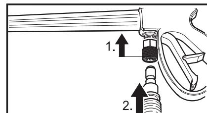
Soltar el cuello y empujar la conexión rápida de la manguera de alta presión hasta que el collar encaje.
