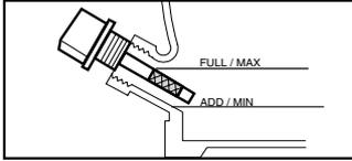
Asegúrese de que la máquina esté nivelada cuando compruebe el nivel de aceite. (Consulte el manual de funcionamiento de la máquina para los grados según la estación). Recomendamos cambiar el aceite tras las primeras 5 horas de uso y después cada 50 horas.
