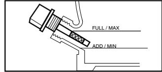
Vérifier que la machine est à l'horizontale lors du contrôle du niveau d'huile. (Se reporter au manuel d'utilisation du moteur pour connaître les différentes qualités d'huile à utiliser en fonction des saisons.)
