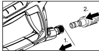
Soltar el cuello y empujar la conexión rápida de la manguera de alta presión hasta que el collar encaje.
