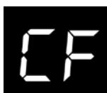
Réinitialiser le filtre de fonction chaque fois que vous remplacez un filtre en débranchant l'appareil de la source d'alimentation, puis rebranchez-le.
