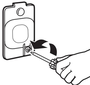
3. Gire el foco en sentido contrario a las manecillas del reloj. Reemplácelo únicamente con un foco para electrodomésticos de 10 vatios. Vuelva a colocar la cubierta en su lugar y asegúrela con el tornillo.
