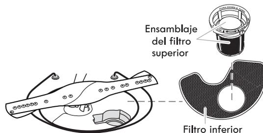
Para proveer un desempeño óptimo de limpieza, sugerimos un mantenimiento mensual del filtro, removiendo e inspeccionando los filtros superior e inferior para ver si están sucios. Según sus hábitos con la lavavajillas, deberá limpiar los filtros con más o menos frecuencia que lo indicado en la tabla a continuación.
