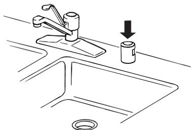
Algunas normas de plomería locales o estatales exigen que se instale una purga de aire del desagüe entre una lavavajillas empotrada y el sistema de desagüe de la casa. Revise la purga de aire del desagüe cuando su lavavajillas no esté desaguando bien.
