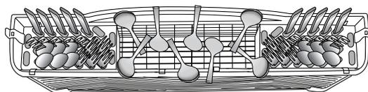
**NOTA:** Si los cubiertos no caben en las ranuras designadas, levante las tapas y mezcle los tipos de cubiertos para mantenerlos separados. Coloque los cuchillos hacia abajo, los tenedores hacia arriba y alterne las cucharas, como se ilustra, para obtener mejores resultados en la limpieza. Cargue los cubiertos más largos en la parte posterior y los más cortos en la parte frontal de la canastilla.
