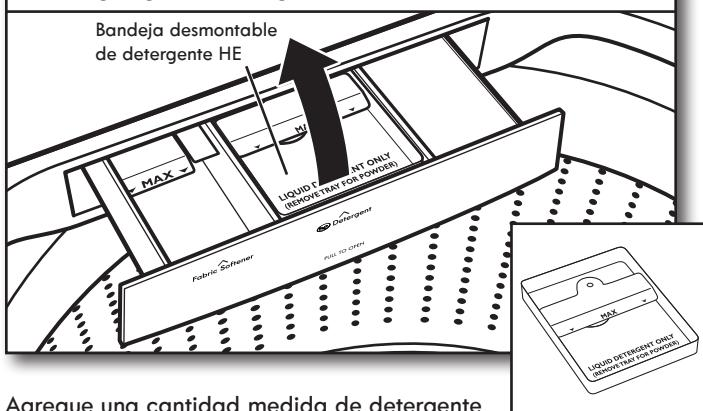
Agregue una cantidad medida de detergente HE en la bandeja de detergente. Esta bandeja tiene una capacidad de 3 onzas (89 mL). Si va a agregar detergente HE en polvo, quite la bandeja interior. No llene en exceso la bandeja. Agregar demasiado detergente puede hacer que se distribuya demasiado pronto en la lavadora.
