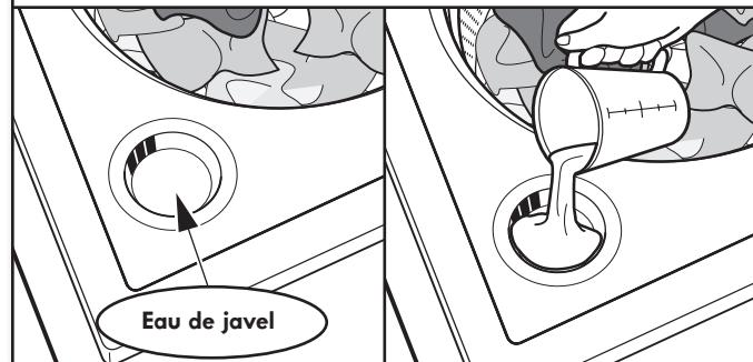
Ne pas remplir excessivement le distributeur, ne pas diluer ni utiliser plus de 1 tasse (236 ml). Ne pas utiliser d'agent de blanchiment sans danger pour les couleurs ni de produit Oxi avec un programme utilisant de l'eau de Javel.
