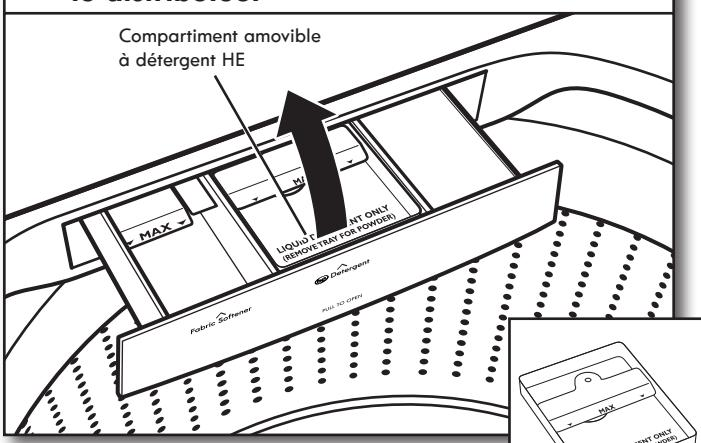
Ajouter une mesure de détergent HE dans le compartiment à détergent. La capacité de ce compartiment est de 3 oz (89 ml). Si l'on ajoute du détergent en poudre HE, retirer le compartiment intérieur. Ne pas faire remplir excessivement le compartiment – le fait d'ajouter trop de détergent peut entraîner sa distribution prématuée dans la laveuse.
