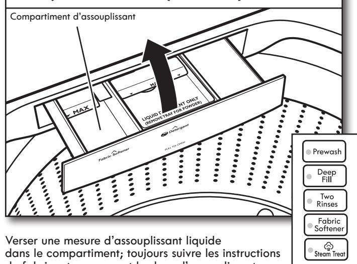
Verser une mesure d'assouplissant liquide dans le compartiment; toujours suivre les instructions du fabricant concernant la dose d'assouplissant utiliser en fonction de la taille de la charge. Fermer le tiroir du distributeur. L'assouplissant est ajouté lors du rinçage.
