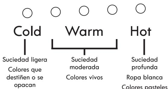
Una vez que haya seleccionado un ciclo, los ajustes predeterminados de ese ciclo se iluminarán. Presione los botones de los modificadores del ciclo para los ajustes de Wash Temp (Temperatura de lavado), el Soil Level (Nivel de suciedad) y Spin Speed (Velocidad centrífugado), si lo desea. No todos los ajustes están disponibles con todos los ciclos. Incluso para los ajustes de lavado con agua fría, se puede agregar un poco de agua tibia a la lavadora para mantener una temperatura mínima.
