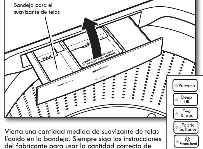
Vierta una cantidad medida de suavizante de telas líquido en la bandeja. Siempre siga las instrucciones del fabricante para usar la cantidad correcta de suavizante de telas según el tamaño de la carga. Cierre el cajón del depósito. El suavizante de telas se agrega durante el enjuague.
