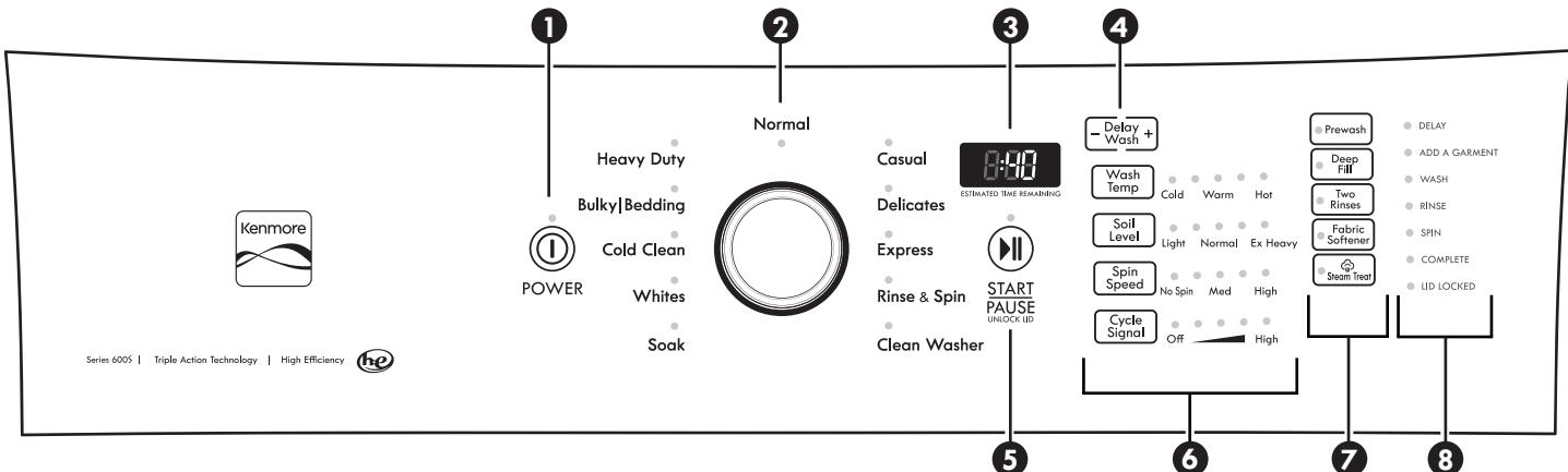
**NOTA:** El panel de control tiene una superficie que responde al toque ligero de los dedos. Para cerciorarse de que se hayan registrado sus selecciones, toque el panel de control con la punta del dedo, no con la uña. Al seleccionar un ajuste o una opción, el hasta que se ilumine la sección deseada.
