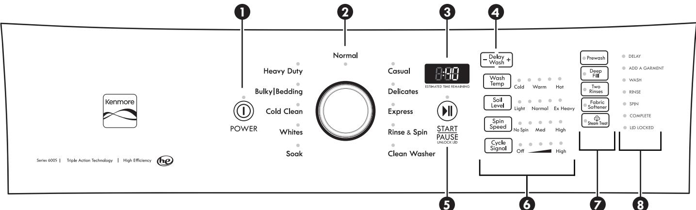
**REMARQUE :** La surface du tableau de commande est très sensible et il suffit d'un léger toucher pour l'activer. Pour s'assurer que vos sélections ont été sauvegardées, toucher le tableau de commande du bout du doigt et non avec l'ongle. Pour sélectionner un réglage ou une option, il suffit de toucher le nom qui lui correspond jusqu'à ce que la section souhaitée s'allume.
