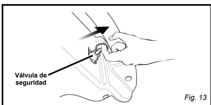
■ Suelte el aro. Al soltar el aro, el aire debe dejar de salir de inmediato. Cualquier pérdida de aire que permanezca después de soltarse el aro de la válvula de seguridad indica un problema en ésta. Interrumpa el uso de la unidad y permita que se dé servicio a la misma antes de volver a usar el compresor.
