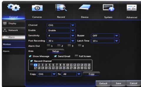
**Pasaje:** seleccione el canal que desea configurar una alarma de movimiento.
