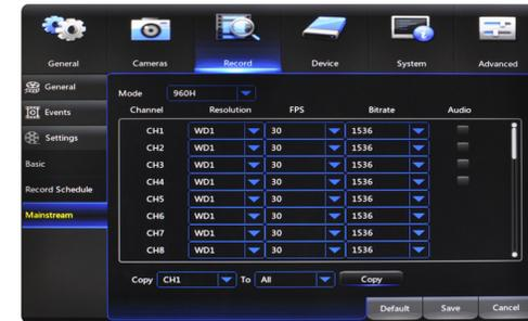
**c. Mainstream:** configure o ajustar la configuración de vídeo para optimizar mejor para su conexión.
