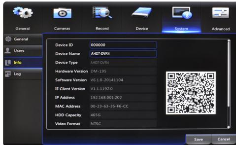
**Dispositivo ID:** cree un número único del dispositivo si está utilizando múltiples DVRs.
