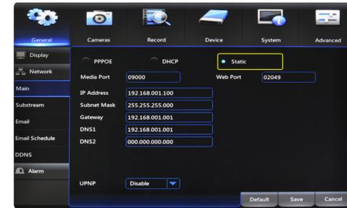
4. Verifique que ambos campos DNS1 y DNS2 se rellenan automáticamente.
