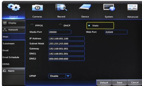
1. Introduzca manualmente la dirección IP en el campo Dirección IP; Este es el número que termina con 150. Usted puede tener que agregar ceros de marcador de posición para cualquiera de las secciones que no contienen tres dígitos por ejemplo, 192.168.1.150 → 192.168.001.150.
