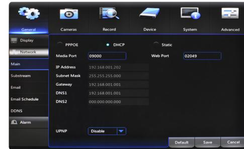
**PPPOE:** para la banda ancha de acceso telefónico sólo los usuarios de la red. Usted tendrá que ponerse en contacto con su ISP para recuperar el nombre de usuario y la contraseña necesaria para completar este tipo de conexión.
