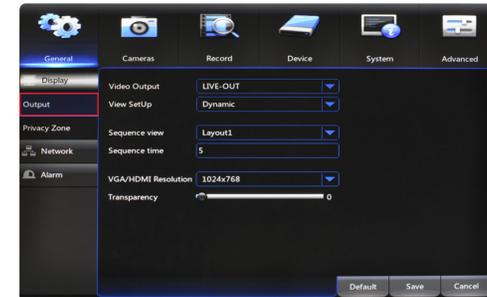
**Salida de Video:** por defecto debe mantenerse en LIVE-OUT.
