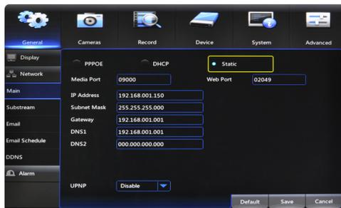
3. Introduzca el número de "Puerta de enlace predeterminada" de la sección anterior. Una vez más usted tendrá que añadir ceros de marcador de posición en cualquiera de las secciones que no contienen tres dígitos por ejemplo, 192.168.1.1 → 192.168.001.001.
