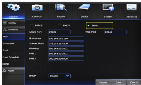
3. Introduzca el número de "Puerta de enlace" de la sección anterior en el campo Gateway. Una vez más usted tendrá que añadir ceros de marcador de posición en cualquiera de las secciones que no contienen tres dígitos por ejemplo, 192.168.1.1 → 192.168.001.001.
