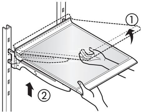
**Para volver a instalar un estante:** incline la parte delantera del estante hacia arriba y guíe los ganchos del estante al interior de las ranuras a la altura deseada. A continuación, baje la parte delantera del estante de manera que los ganchos caigan en las ranuras.
