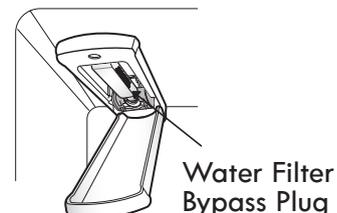
**⚠ PRECAUCIÓN:** NO ponga en marcha el frigorífico sin tener un filtro de agua o un tapón de derivación del filtro de agua instalado.
