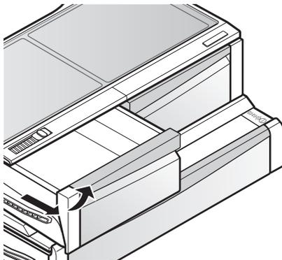
3. Para instalarlo, incline la parte delantera ligeramente hacia arriba, inserte el cajón en el marco y empuje hasta que encaje en su sitio.
