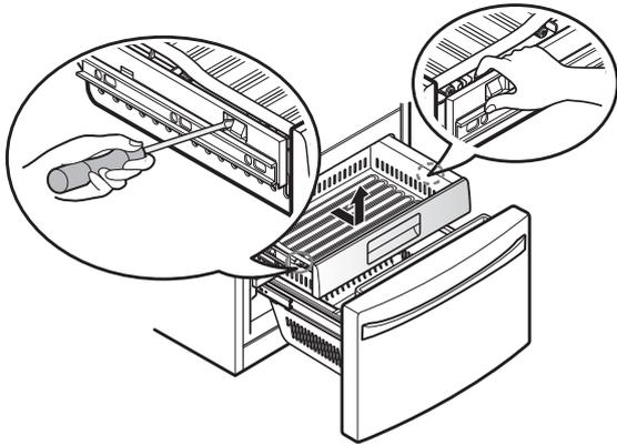
2. Para volver a colocarla, incline levemente hacia arriba la parte delantera de la gaveta, inserte la gaveta en el marco y empújela en su lugar hasta que escuche un clic.
