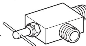
**NOTA:** No se debe usar una válvula de agua de tipo de montura autopercorante.
