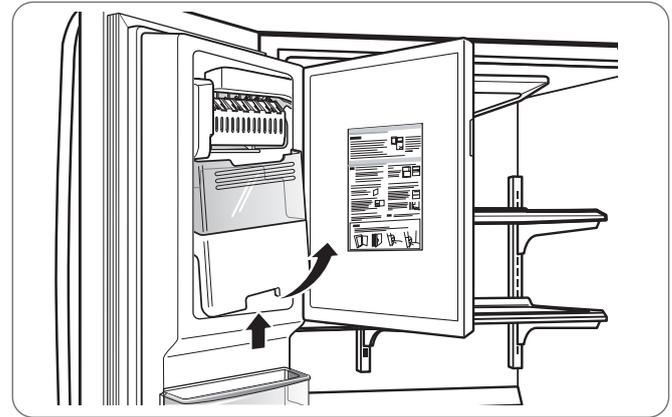
3. Para volver a instalar el depósito de hielo del interior de la puerta, incline ligeramente el depósito al volver a colocarlo en su sitio para evitar el contacto con la máquina de hielo.
