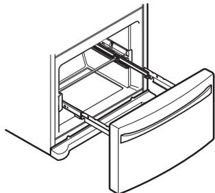
Con las dos manos, sujete la barra central y empújela hacia dentro de forma que ambos rieles se deslicen de forma simultánea.
