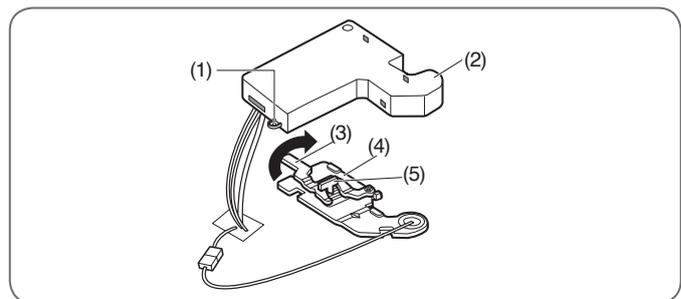
1. Abra la puerta. Retire el tornillo de la tapa de la bisagra superior (1). Levante la tapa (2).
