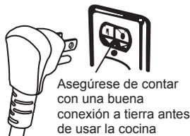
No utilice un enchufe adaptador. Desconectar el cable de alimentación genera tensión indebida en el adaptador y genera una falla eventual en el terminal a tierra del adaptador.
