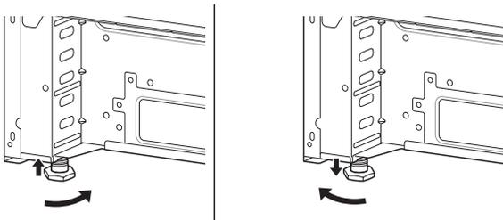
Utilice un nivelador para verificar sus ajustes. Ubique el nivelador en diagonal sobre el estante y verifique en todas direcciones, para nivelar.
