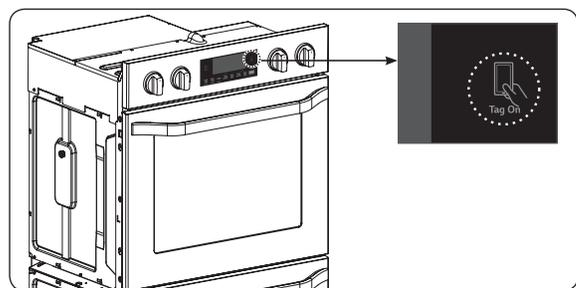
Busque el icono Tag On a lado de la pantalla en el panel de control. Es ahí donde usted tiene que poner el teléfono inteligente para usar la función Tag On y las funciones "LG Smart Diagnosis™", fijar el modo de cocinado y la función EasyClean® junto con la aplicación LG Smart ThinQ
