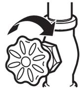
9 CONECTE LA TUBERÍA AL REFRIGERADOR
