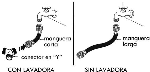
**Apriete bien todas las conexiones de las mangueras de suministro de agua a mano y luego ajuste otros 2/3 de vuelta con pinzas.**
