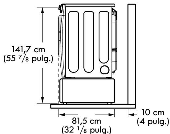
Dimensiones requeridas para la instalación con el kit para montaje sobre la lavadora
