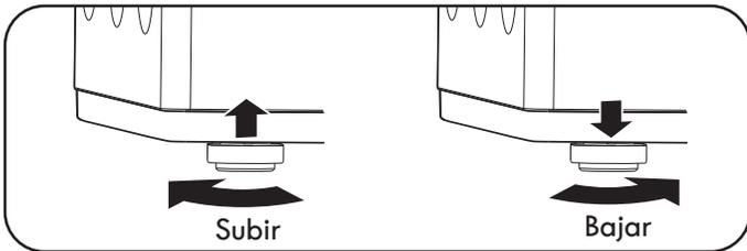
2. Ajuste la pata niveladora. Gire en sentido horario para levantar la lavadora y en sentido antihorario para bajarla.
