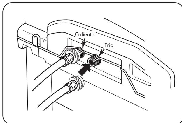
4. Conecte la tubería de agua caliente (roja) a la entrada de agua caliente ubicada en la parte trasera de la lavadora. Conecte la tubería de agua fría (azul) a la entrada de agua fría situada en la parte posterior de la lavadora. Ajuste las uniones con firmeza. Abra las llaves de paso del agua y revise si hay fugas.
