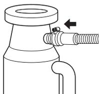
**Conexión a la pieza en T para desechos sin trampa de aire**
