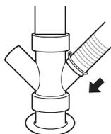
**Conexión al triturador o a la pieza en T para desechos con trampa de aire**
