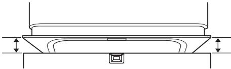
Se debe verificar el nivel de agua después del llenado inicial en el ciclo Normal. Si el nivel de agua no está cerca del centro de ambas muescas inferiores de la cuba, es posible que el lavavajillas no esté nivelado correctamente. El lavavajillas puede tener pérdidas durante el funcionamiento si no está correctamente nivelado.
