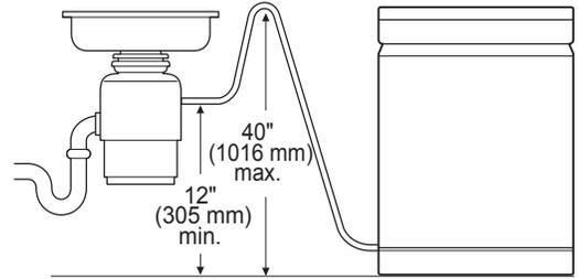
Si el extremo de la manguera de desagüe no se adapta a la línea de desagüe, use un adaptador resistente al calor y al detergente (no está incluido). Este accesorio se puede comprar en una tienda local de artículos de fontanería.
