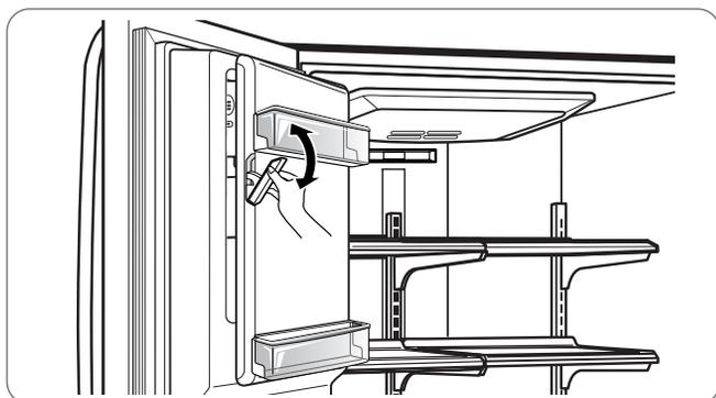
2. Para sacar el depósito de hielo del interior de la puerta, agarre la manija delantera, levante ligeramente la parte inferior y despiace saque el depósito tal como se muestra.
