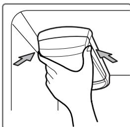
**NOTA:** Al reemplazar el filtro de agua se drena una pequeña cantidad de agua (unos 25 cc). Coloque un vaso debajo de la parte delantera de la tapa del filtro de agua para recoger el agua que se escape. Sostenga el filtro de agua en posición vertical, una vez retirado, para evitar que el agua residual se salga del filtro de agua.
