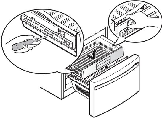
2. Para volver a colocarla, incline levemente hacia arriba la parte delantera de la gaveta, inserte la gaveta en el marco y empújela en su lugar hasta que escuche un clic.
