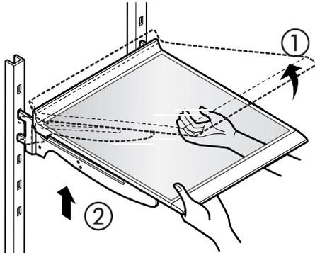
**Para volver a instalar un estante:** incline la parte delantera del estante hacia arriba y guíe los ganchos del estante al interior de las ranuras a la altura deseada. A continuación, baje la parte delantera del estante de manera que los ganchos caigan en las ranuras.
