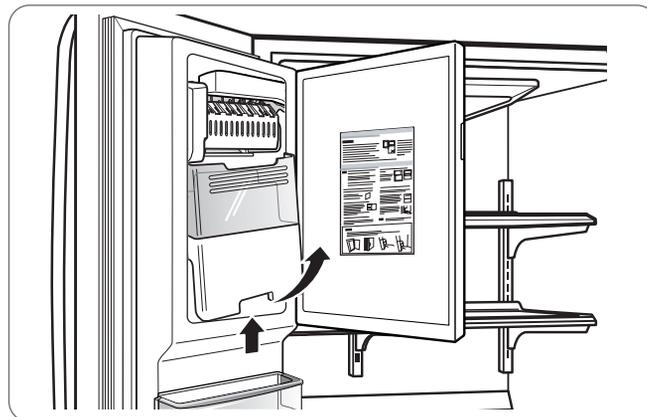
3. Para volver a instalar el depósito de hielo del interior de la puerta, incline ligeramente el depósito al volver a colocarlo en su sitio para evitar el contacto con la máquina de hielo.
