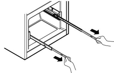
Sujete el cajón por cada lado y enganche los soportes de la puerta **①** para introducirlos en las pestañas de los rieles **②** que hay a ambos lados.
