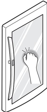
1. Toque dos veces el vidrio para encender y apagar la luz de LED dentro de la puerta LID.
