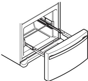
Con las dos manos, sujete la barra central y empújela hacia dentro de forma que ambos rieles se deslicen de forma simultánea.
