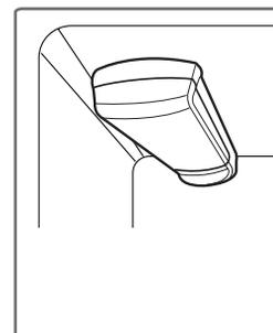
3. Después de reemplazar el filtro de agua, dispense 9 litros de agua (deje correr el agua durante unos 5 minutos) para purgar el aire atrapado y los contaminantes del sistema; no dispense los 9 litros de agua de manera continua. Pulse y suelte el botón del dispensador en ciclos de 30 segundos ON y 60 segundos OFF.
