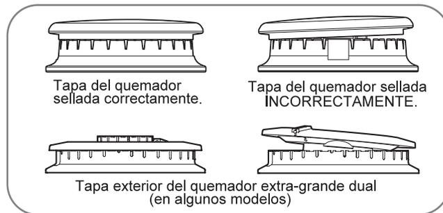
Para colocar correctamente la tapa exterior del quemador extra-grande dual, asegúrese de que la hendidura que se encuentra en la tapa del quemador quede situada sobre la guía de montaje de la cabeza del quemador.
