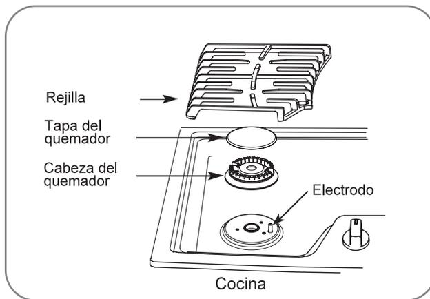
**⚠ PRECAUCIÓN:** No desmonte ninguna pieza de la cocina hasta que se haya enfriado por completo y su manipulación sea segura. No ponga en funcionamiento los quemadores sin que todas las piezas de los quemadores y las rejillas estén en colocadas en su sitio.
