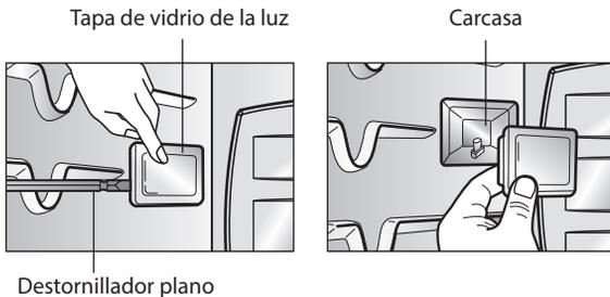
**Para reemplazar una lámpara ubicada en la pared superior:**
