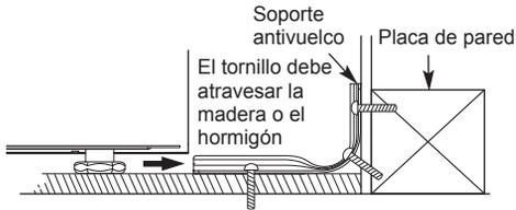
Se incluye un soporte antivuelco con una plantilla de instalación. Las instrucciones incluyen la información necesaria para completar la instalación. Lea y siga la hoja de instrucciones de instalación de la cocina.
