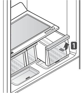
Para instalarlo, incline la parte delantera ligeramente hacia arriba, inserte el cajón en el marco y empuje hasta que encaje en su sitio.
