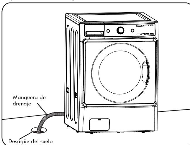
Inserte el extremo de la manguera de drenaje en el desagüe del suelo. Si es posible, fije la manguera para evitar que se mueva o se salga del desagüe.
