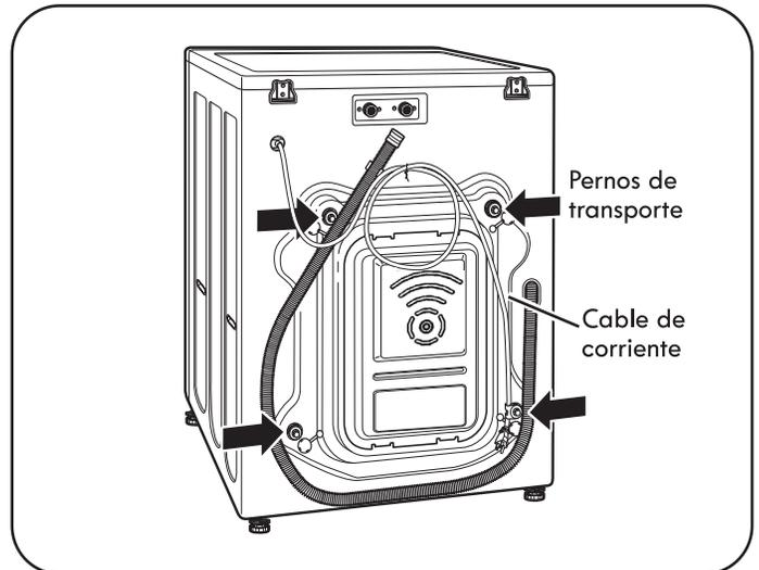
1. Comience con los dos pernos de transporte inferiores y utilice llave de pernos (incluida) para aflojar completamente los cuatro pernos de transporte girándolos hacia la izquierda.
