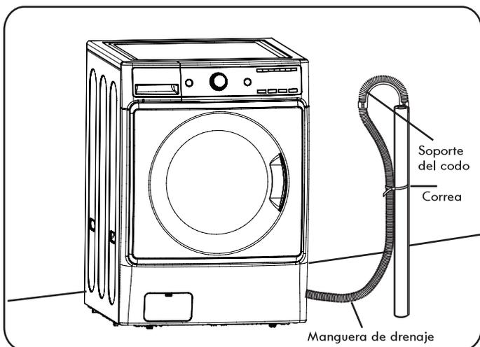
Ingrese el extremo de la manguera de drenaje en el soporte del codo. No extienda la manguera de drenaje más de 10,1 cm (4 pulgadas) más allá del extremo del soporte del codo. Use una correa para asegurar la manguera de drenaje en su lugar.
