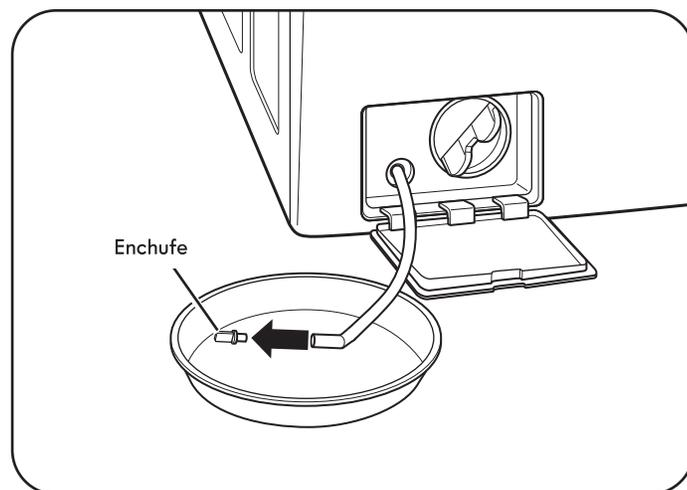
**3** Retire el conector de la manguera de drenaje y permita que el agua drene por completo.
