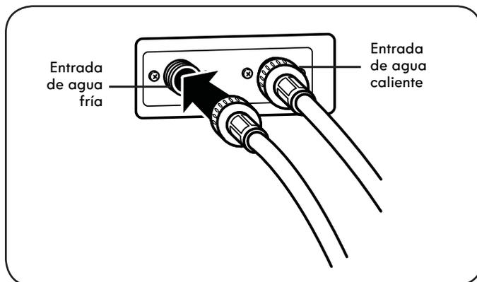
4. Conecte la tubería de agua caliente (roja) a la entrada de agua caliente ubicada en la parte trasera de la lavadora. Conecte la tubería de agua fría (azul) a la entrada de agua fría situada en la parte posterior de la lavadora. Ajuste las uniones con firmeza.
