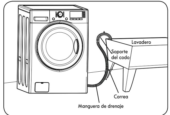
El soporte de codo debe estar instalado cerca del extremo de la manguera de drenaje. Cuelgue el extremo de la manguera de drenaje por el lado del sumidero de agua. Use una correa para asegurar la manguera de drenaje en su lugar.
