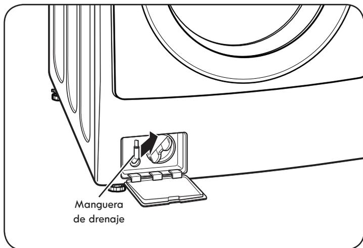
**2** Desconecte la manguera de drenaje y tire de ella. Coloque el extremo de la bomba de drenaje en un recipiente llano o en el desagüe del suelo. Asegúrese de no tirar demasiado la manguera, o es posible que no drene de manera adecuada.
