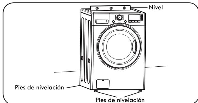
1. Coloque la lavadora en su ubicación final, teniendo especial cuidado de no presionar, tirar excesivamente o aplastar las tuberías de agua y drenaje. Coloque un nivel sobre la parte superior de la lavadora.
