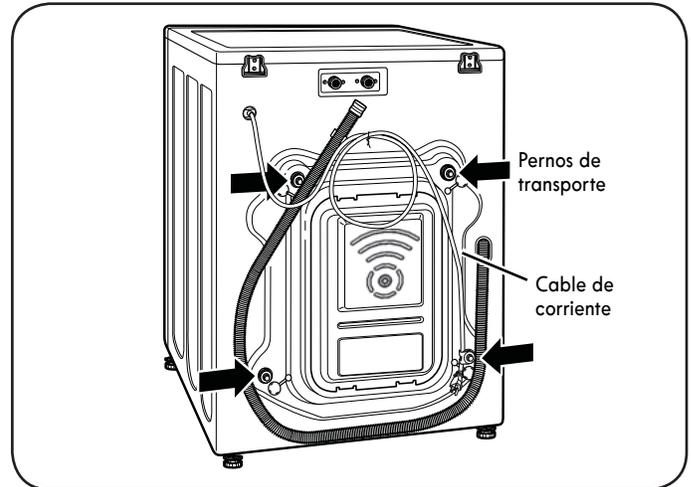
1. Comience con los dos pernos de transporte inferiores y utilice la llave de pernos (incluida) para aflojar completamente los cuatro pernos de transporte girándolos hacia la izquierda.
