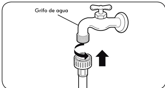
2. Conecte las mangueras de suministro de agua a las llaves de paso de agua CALIENTE y FRÍA y apriete las conexiones con la mano. A continuación, utilice unos alicates para apretarlas otros  $\frac{2}{3}$  de vuelta.
