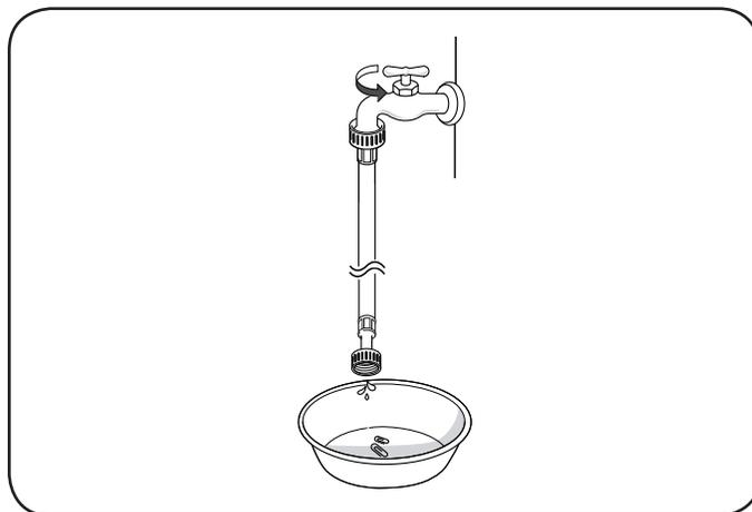
3. Siempre deje fluir unos cuatro litros de agua a través de cada manguera de entrada para ayudar a evitar futuros problemas con pantallas de filtro obstruidas al vaciar la suciedad, depósitos de minerales y otros residuos de las tuberías de agua. De paso, al hacerlo comprobará cuál es la manguera de agua caliente y cuál la de agua fría.
