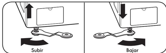
2. Afloje las tuercas de fijación de las cuatro patas de nivelación con la llave hasta que ajuste las patas (el aspecto de la llave puede variar). Utilice la llave para girar las patas hacia la derecha para elevar la lavadora, y en sentido contrario para bajar la lavadora. Con un nivel, ajuste las patas hasta que la lavadora quede nivelada de lado a lado y de adelante hacia atrás. Asegúrese de que las cuatro patas estén en contacto directo con el suelo.
